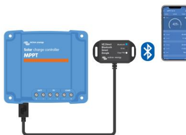
Připojení aplikace VictronConnect přes Bluetooth pomocí VE.Direct Bluetooth Smart Dongle.
